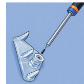
3 ใช้ Y4K.15010 ตัดสะพานเชื่อมและใช้ไขควงแบบมือหมุน 1431-DV ขันยึดเพื่อนำออกจากกล่อง
